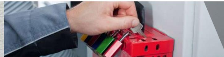
Con este dispositivo, el responsable del mantenimiento puede bloquear todos los puntos de acceso de energía, para entonces guardar las llaves en la caja. Los demás usuarios colocan sus candados personalizados en la caja, por lo que la energía no puede ser restablecida hasta que todos los usuarios hayan terminado sus labores.
